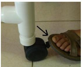
۳- پس از نصب چرخها، جهت راه اندازی ترمزهایی که در دو چرخ عقب ویلچر تعییه شده است، قسمت پلاستیکی این دو چرخ (ترمزها) را با پا به سمت پایین فشار دهید.
