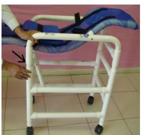
۴- صندلی ویلچر را مطابق شکل به پایه ارتفاع دهنده (چهارپایه) وصل کنید.
